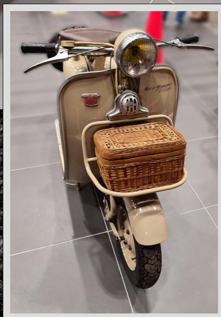
*En 1956, parallèlement au SB/SV, apparaît la version « habillée » SBH/SVH : le tablier monte jusqu'au guidon et le moteur, doté d'une vraie turbine de refroidissement est masqué par deux panneaux latéraux amovibles. Ainsi grées, les Moby se posaient en concurrents des Vespa et Lambretta, mais ils n'avaient pas l'argument prix.*
