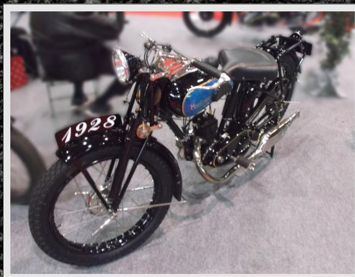
*Ce modèle qui fait suite au type « A », par souci d'économie, retrouve le moteur à cylindre borgne des RC3C, et du coup abandonne aussi le graissage séparé, ces évolutions qui seront réservées à des modèles de plus haut de gamme*
